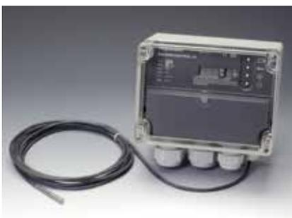
**Les thermostats électroniques** mesurent la température au moyen d'un circuit électronique câblé à une sonde de température. Les modèles plus évolués proposent des fonctions supplémentaires telles qu'un afficheur de température, des alarmes de températures élevées/basses ou encore la régulation proportionnelle à température ambiante. Ils sont principalement réservés aux applications de maintien en température exigeant une plage de températures étroite.
